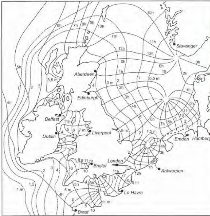
Abb. 3-106 Die amphidromischen Punkte der Nordsee, die Zeitlinien der umlaufenden Flutwellen und der Gezeitenunterschied zwischen Hoch- und Niedrigwasser (Springtide) (aus Sager 1959, Bild 47).
